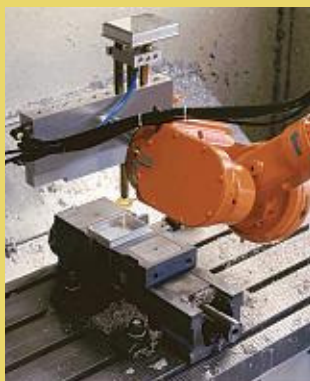
■ De robot plaatst de werkstukken in een pneumatisch opspanstelsysteem op de tafel van het bewerkingscentrum
