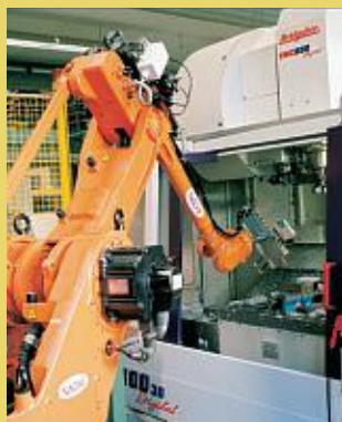
■ Heemskerk heeft een Nachi handlingrobot aan een Bridgeport bewerkingscentrum gekoppeld (foto's: Erik Steenkist)
