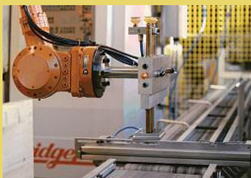
■ Na het frezen worden opspanstelsysteem en product schoongespoten, vervolgens neemt de robot het product op en plaatst deze op een lopende band
