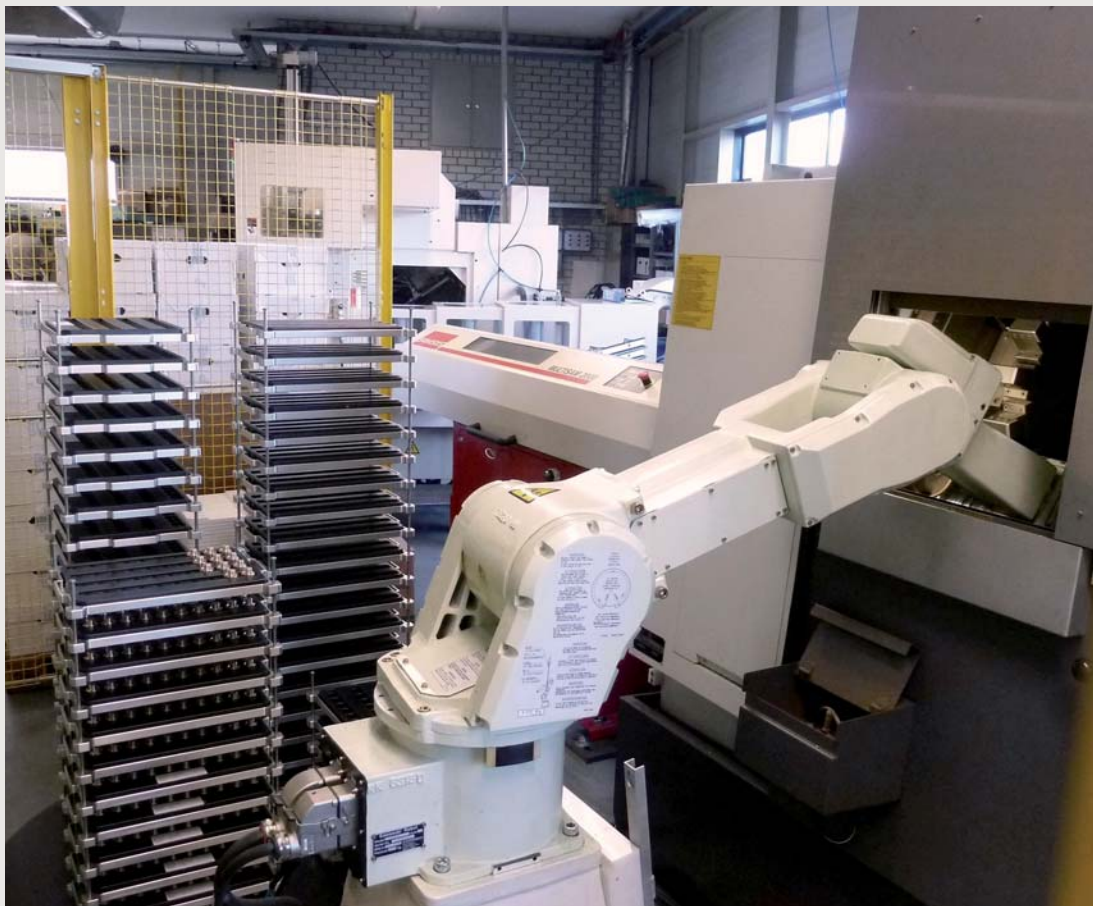
Deze productiecel is geheel door Heemskerk zelf ontwikkeld inclusief aangepaste staflander en productpallets (foto's: Paul Quaedvlieg)
