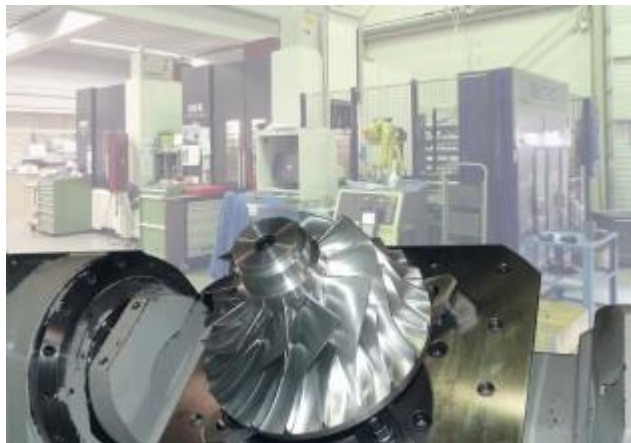
Complex werkstuk gefreesd door Heemskerk Fijnmechanica op een vijfassige OKK (foto's: Heemskerk Fijnmechanica)
